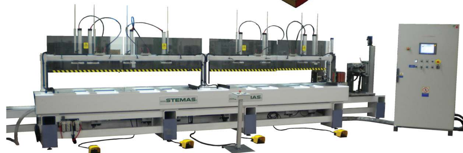
WAVE TO ROZWIĄZANIE DO OKLEJANIA WĄSKICH POWIERZCHNI I FREZOWANIA NADMIARU OBRZEŻA ELEMENTÓW KRZYWOLINIOWYCH, Z 2 LUB 4 KONTROLOWANYMI OSIAMI .
