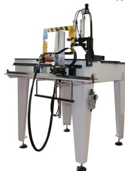
MAN-TRIM TO OBSŁUGIWANA RĘCZNIE MASZYNA DO FREZOWANIA NADMIARU OBRZEŻA NA Kształtach TYPU "J".
