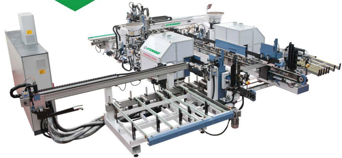
**PERFECT-STEP** IST DIE VOLLKOMMEN KUNDENSPEZIFISCH GESTALTBARE MASCHINE FÜR DEN SCHNITT IM 90°- UND 45°-WINKEL, DAS FRÄSEN, DIE KANTENBEARBEITUNG, DAS KANTENANLEIMEN, DAS BESCHNEIDEN, DIE FOLIERUNG, DAS BOHREN, DAS ANBRINGEN VON STIFTEN UND DAS SCHLEIFEN.
