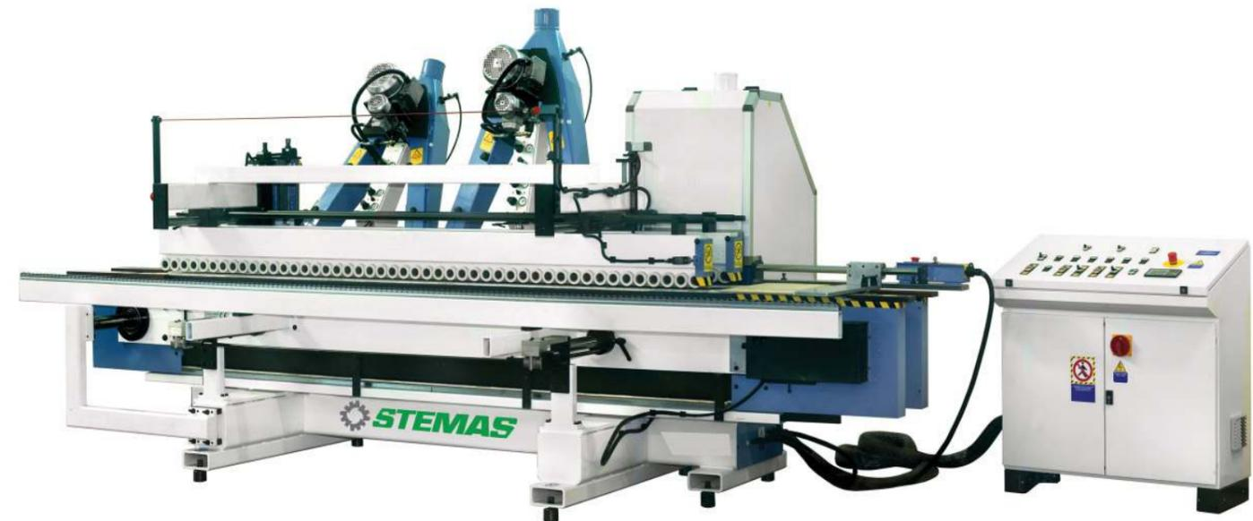
**E-SAND** IST DIE LÖSUNG ZUM SCHLEIFEN UNBEHANDELTER UND LACKIERTER PLATTENKANTEN.
