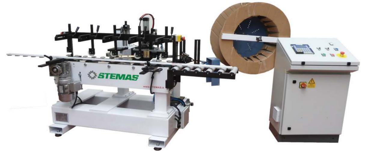
MASCHINE ZUM EINSETZEN DER DICHTUNG
