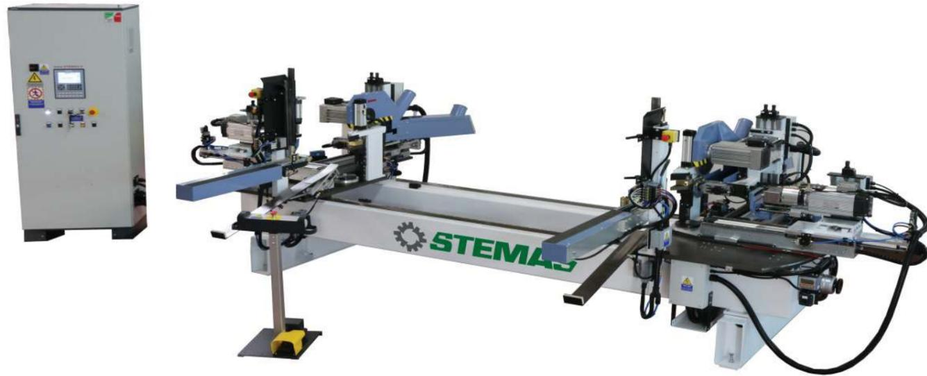
STATISCHE MASCHINE FÜR DEN SPIEGELSCHNITT UND DAS BOHREN IM 45°- UND 90°-WINKEL.
