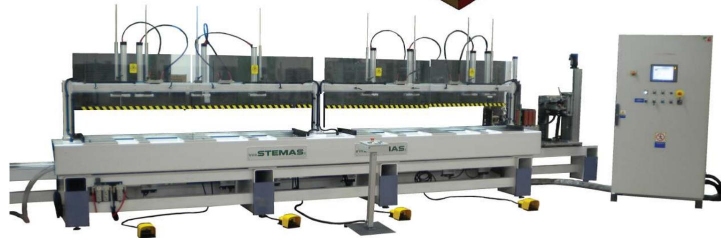
**WAVE** IST DIE LÖSUNG FÜR DAS KANTENANLEIMEN UND BESCHNEIDEN GEBOGENER WERKSTÜCKE MIT 2 ODER 4 GESTEUERTEN AXSEN.
