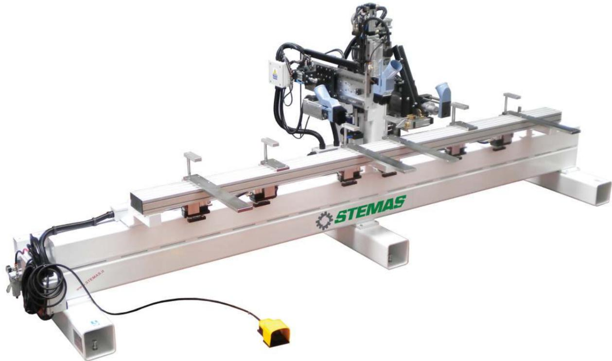
FRÄSEN FÜR SCHARNIERE, SCHLÜSELLÖCHER UND KLINKEN UND BOHRUNGEN FÜR TÜRBÄNDER. SIE KANN SOWOHL DIE TÜRFÜLLUNGEN ALS AUCH DIE TÜRRAHMEN BEARBEITEN.
