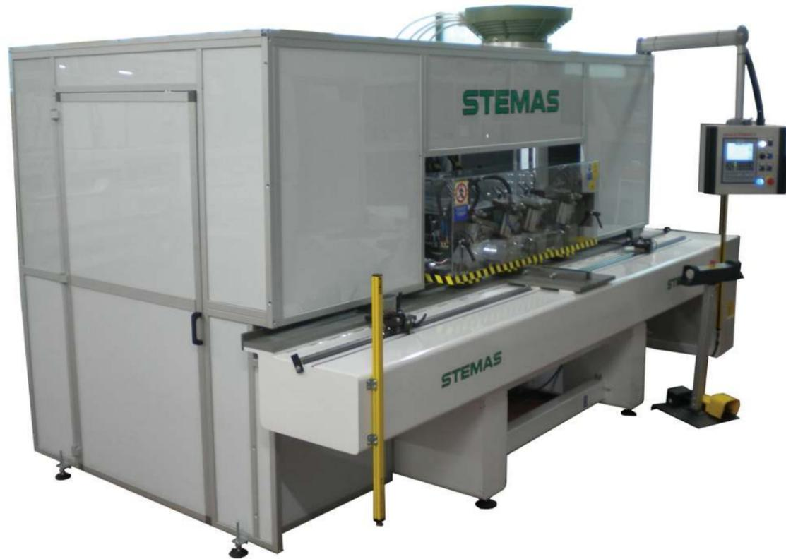
STATISCHE MASCHINE FÜR DAS FRÄSEN, VERSTIFTEN UND EINSETZEN VON STIFTEN IN DIE VERTIKALEN UND QUERRAHMEN VON MÖBELTÜREN MIT FRANZÖSISCHER VERBINDUNG.
