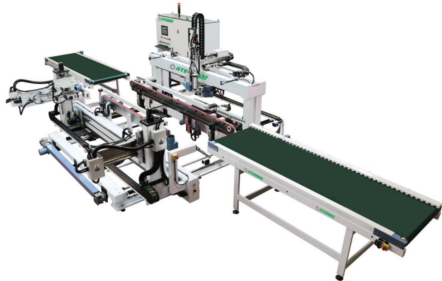
**PERFECT-DOOR** IST DIE EINSTIEGSLÖSUNG ZUR BEARBEITUNG VON TÜRFÜLLUNGEN. GRAVUR MIT PANTOGRAPH, ÖFFNUNG ZUM EINSETZEN DER GLASSCHEIBE, ABVIERUNG, FRÄSEN DES SITZES FÜR SCHLOSS, SCHLÜSSEL, KLINKE UND SCHARNIERE.
