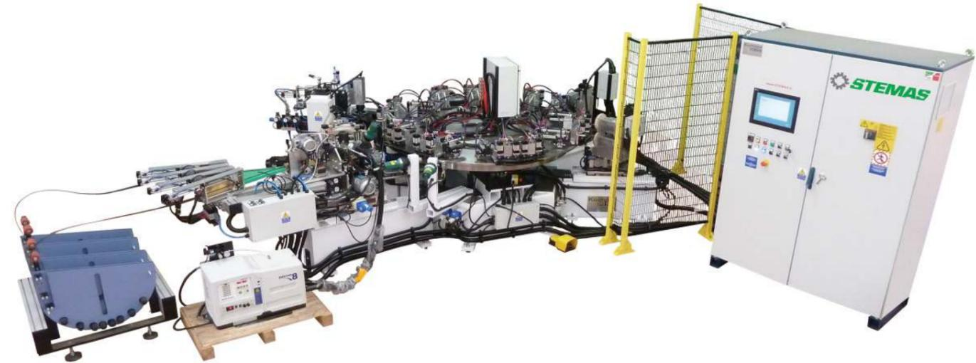
**ROTARY** IST EIN BEARBEITUNGSZENTRUM MIT DREHPALETTE, DAS FÜR VERSCHIEDENE BEARBEITUNGSPROZESSE KUNDENSPEZIFISCH GESTALTET WERDEN KANN: KANTENANLEIMEN, BESCHNEIDEN, POLIEREN, FRÄSEN UND SCHLEIFEN.
