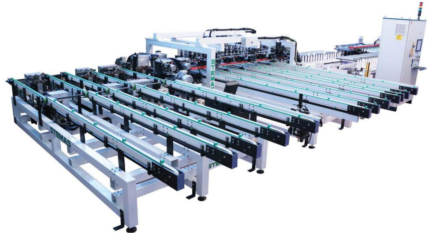
MONTAGE DER ABDECKLEISTEN AM ZENTRALEN ELEMENT MIT PUR-LEIM ODER SCHMELZKLEBER.
