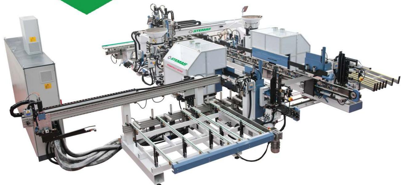
**PERFECT-STEP** для облицовывания кромки, обрезки кромки, фрезерования, резка 90° или 45°, снятие фаски, горячее тиснение, сверление и вставка шпона, прокатка и шлифование
