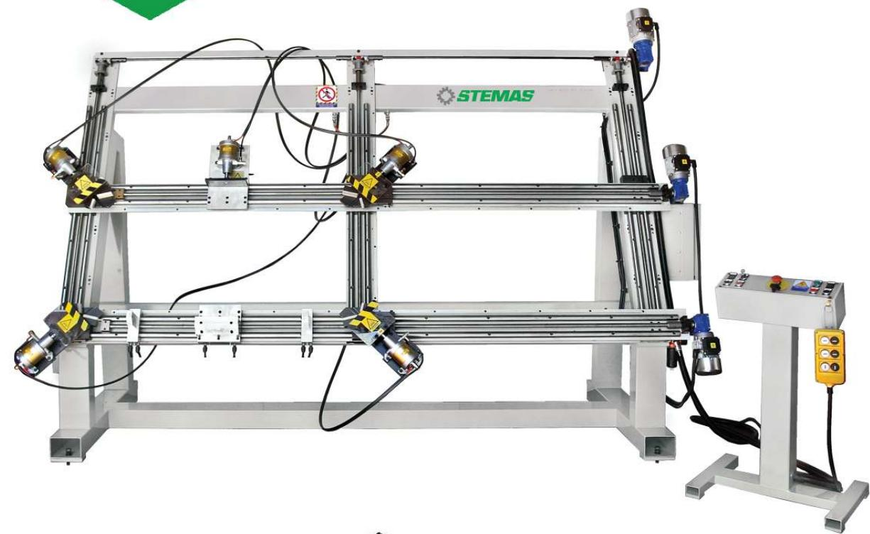
**EASY-CLAMP** автоматическая установка для упрощения
