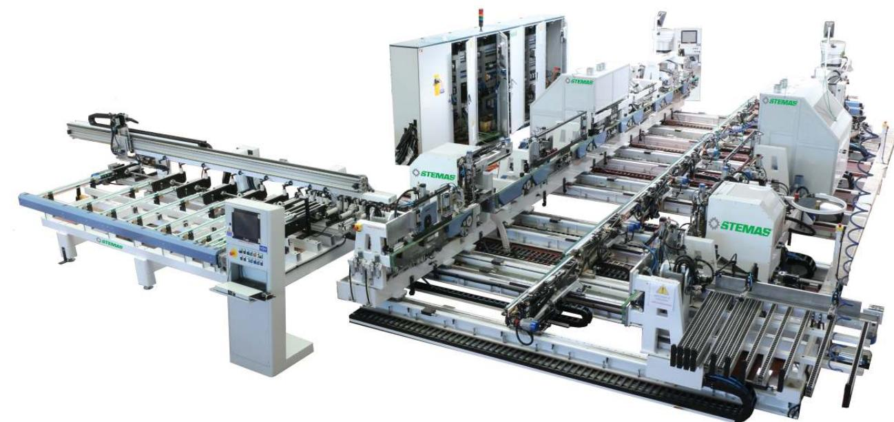
**FLEX-STEP** установка, позволяющая обрабатывать независимые боковые отверстия. Система может одновременно обрабатывать заготовки различных длин по принципу «синхронная работа»
