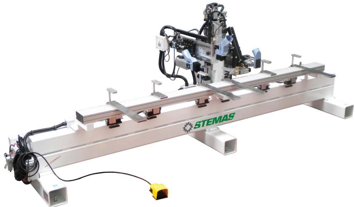
Ручка, замок, петли, фрезерование и сверление по обеим сторонам дверных панелей и дверных стоек
