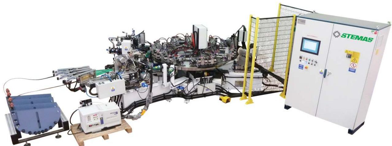
**ROTARY** рабочий центр карусельного типа с вращающейся рамой, подходит для выполнения различных рабочих процессов: облицовывание, снятие кромки, полирование, фрезерование и шлифование
