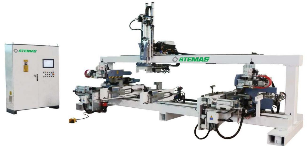
**EASY-JAMB** EST LA SOLUTION SIMPLE ET PERSONNALISABLE POUR L'USINAGE DES MONTANTS ET DES TRAVERSES DE CADRES DE PORTE. COUPE A 45° ET 90°, PERÇAGE POUR JOINTS, FRAISAGE POUR CONTRE-PLAQUE ET CHARNIERES, PERÇAGE ET VISSAGE D'ANUBA. CHARGEMENT ET DECHARGEMENT MANUEL
