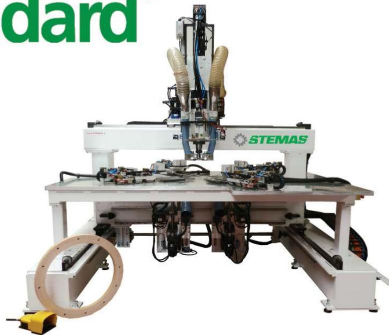
SOLUTION POUR FRAISER, PERCER ET PONCER LES ELEMENTS RONDS
