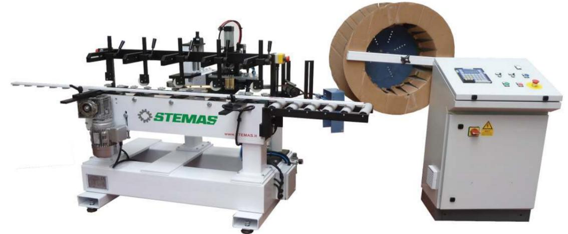
MACHINE POUR LA POSE DU JOINT
