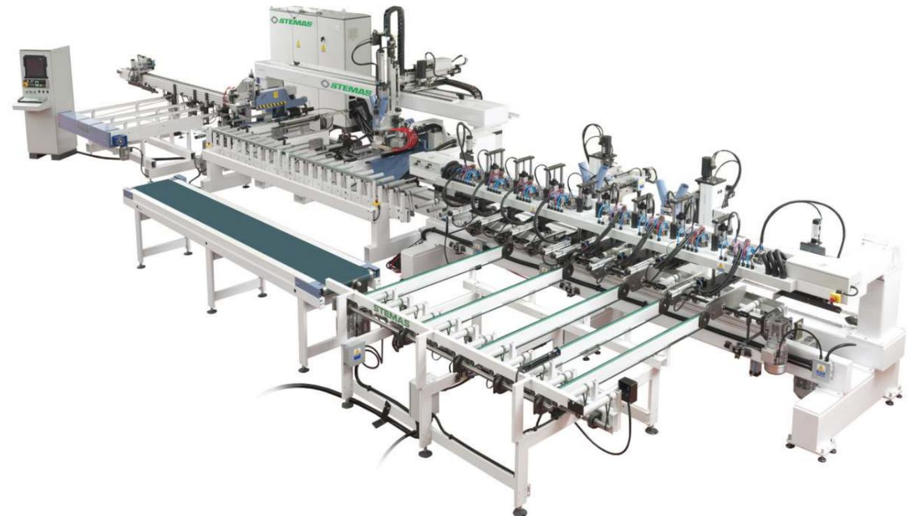
**PERFECT-JAMB-HP** EST UNE LIGNE À HAUTE PRODUCTIVITÉ ET CUSTOMISÉE POUR LA PRODUCTION DES CADRES DES PORTES. CHARGEUR AVEC PINCE CNC AVEC POSE DU JOINT. COUPE À 45° ET 90°, PERÇAGE POUR JONCTIONS, FRAISAGE POUR CONTRE-PLAQUE ET CHARNIÈRES, PERÇAGE ET VISSAGE D'ANUBA. SYSTÈME DE RETOUR PIÈCES POUR PERMETTRE À UN SEUL OPÉRATEUR DE CHARGER ET DÉCHARGER LA MACHINE DANS LA MÊME POSITION
