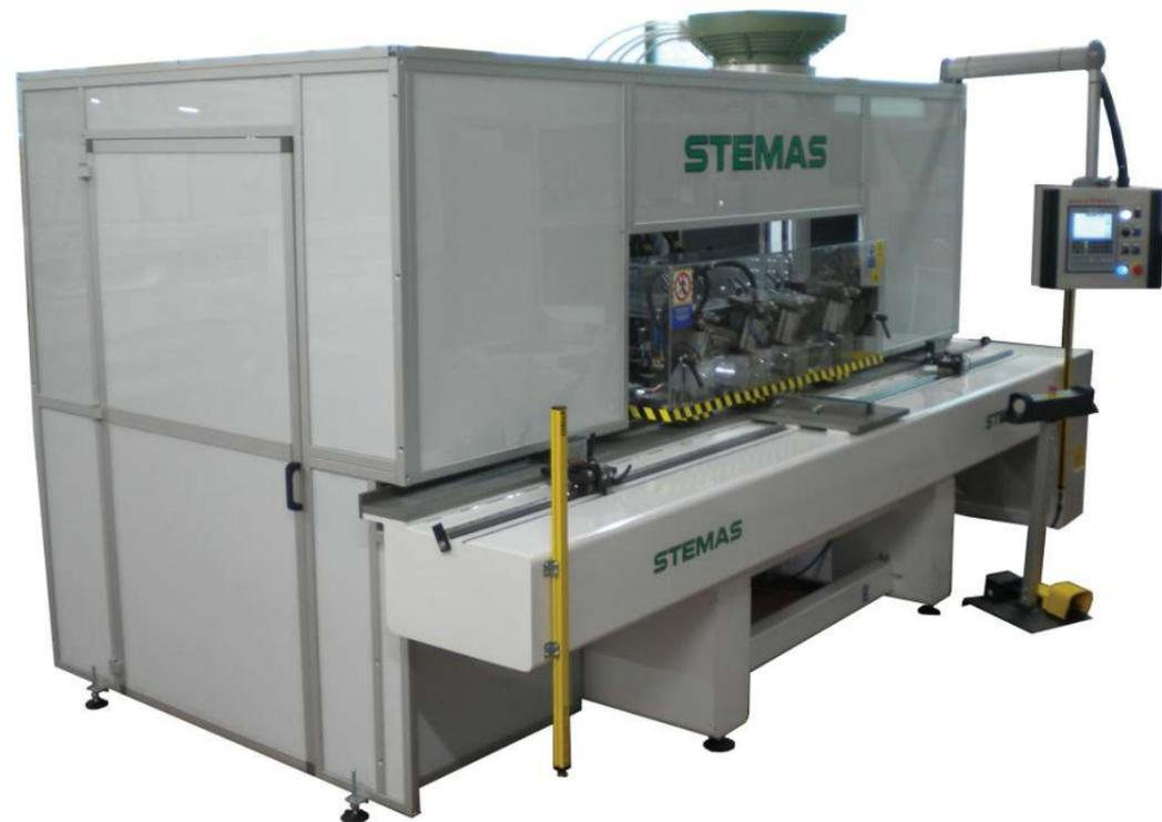
MACHINE STATIQUE POUR FRAISER, ET INSERER DES TOURILLONS SUR LES MONTANTS ET LES TRAVERSES DE PORTES DE CUISINE AVEC JONCTIONS A LA FRANCAISE
