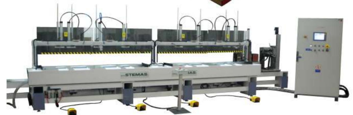
**WAVE** ES LA SOLUCIÓN PARA EL CANTEADO Y REFILADO DE PIEZAS CURVAS CON 2 O 4 EJES CONTROLADOS
