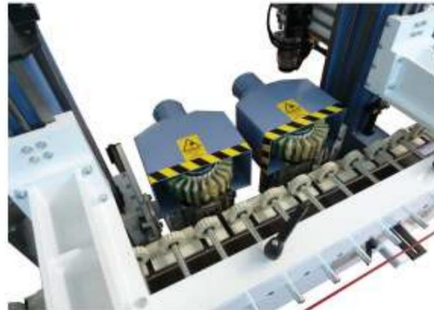
LIJADO MEDIANTE DISCOS
