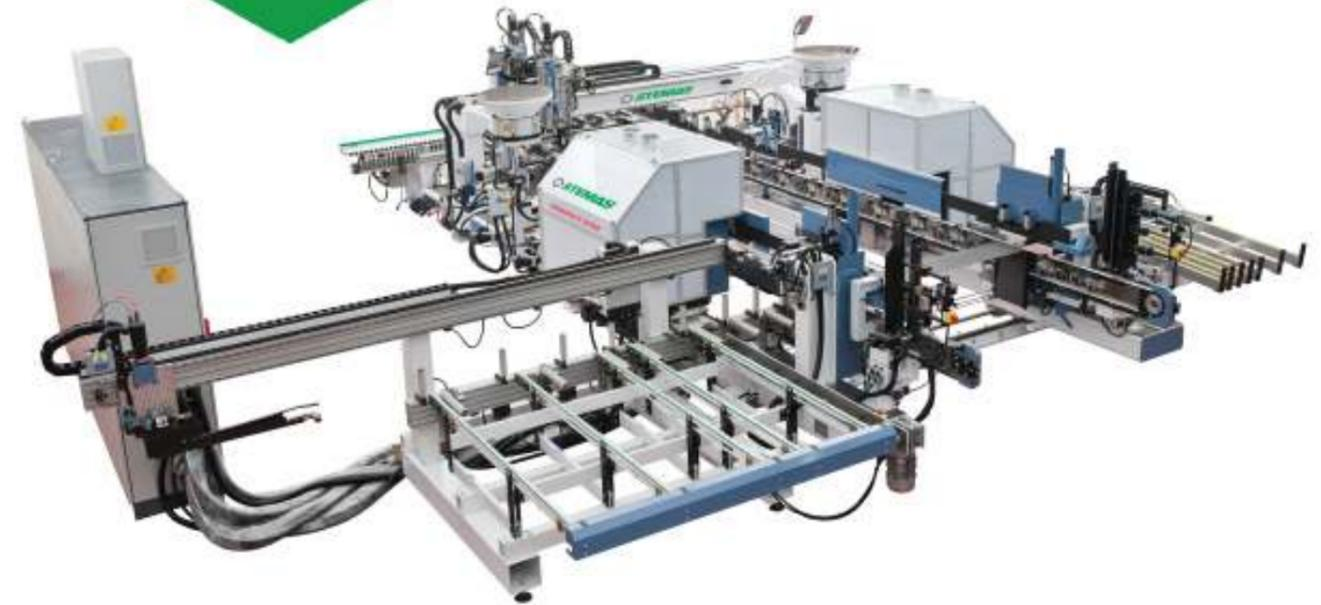
**PERFECT-STEP** ES LA MÁQUINA COMPLETAMENTE PERSONALIZABLE PARA EL CORTE A 90° Y 45°, FRESADO, PERFILADO, CANTEADO, REFILADO, PEGADO DE FILM/STAMPING, TALADRADO, INSERCIÓN DE CLAVIJAS Y LIJADO
