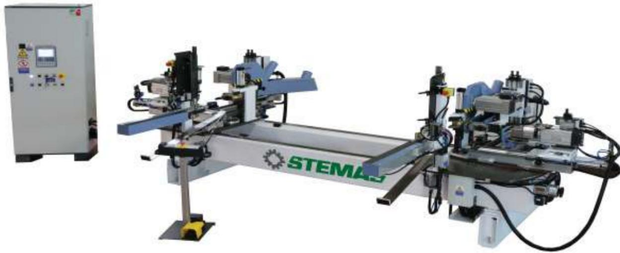
MÁQUINA ESTÁTICA PARA EL CORTE RADIAL Y TALADRADO A 45° Y 90°
