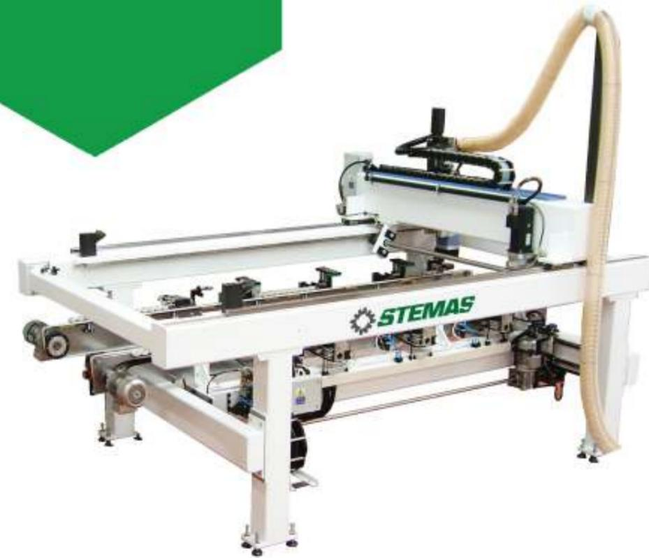
SOLUCIÓN PASANTE PARA EL FRESADO Y EL SECCIONADO DE PANELES PARA PUERTAS
