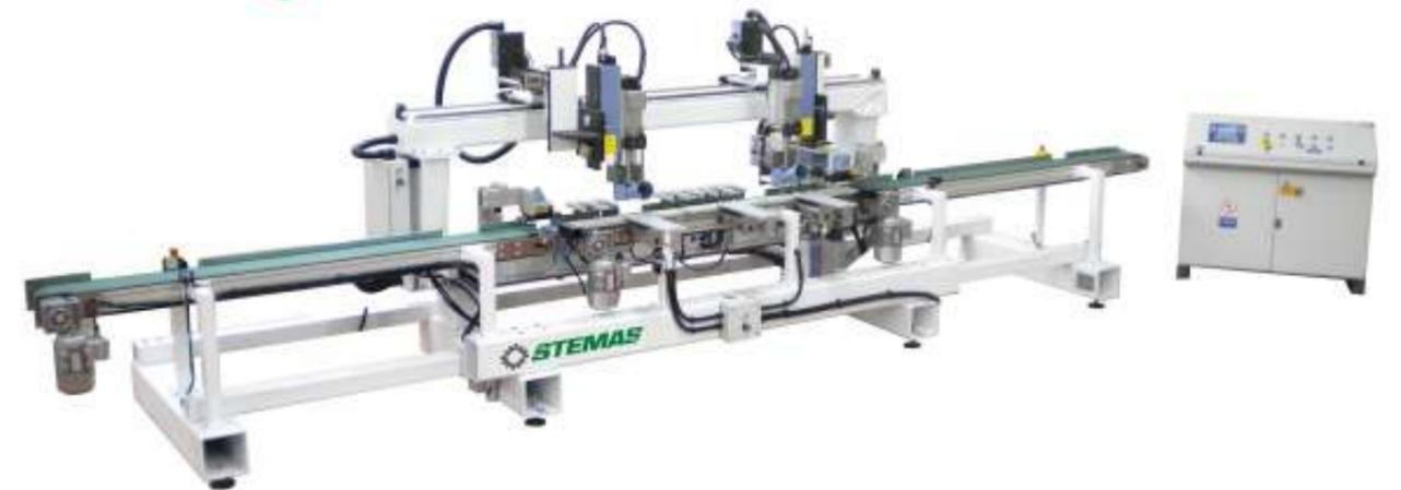
SOLUCIONES PASANTES PARA EL TALADRADO Y FRESADO DE COMPONENTES PARA VENTANAS
