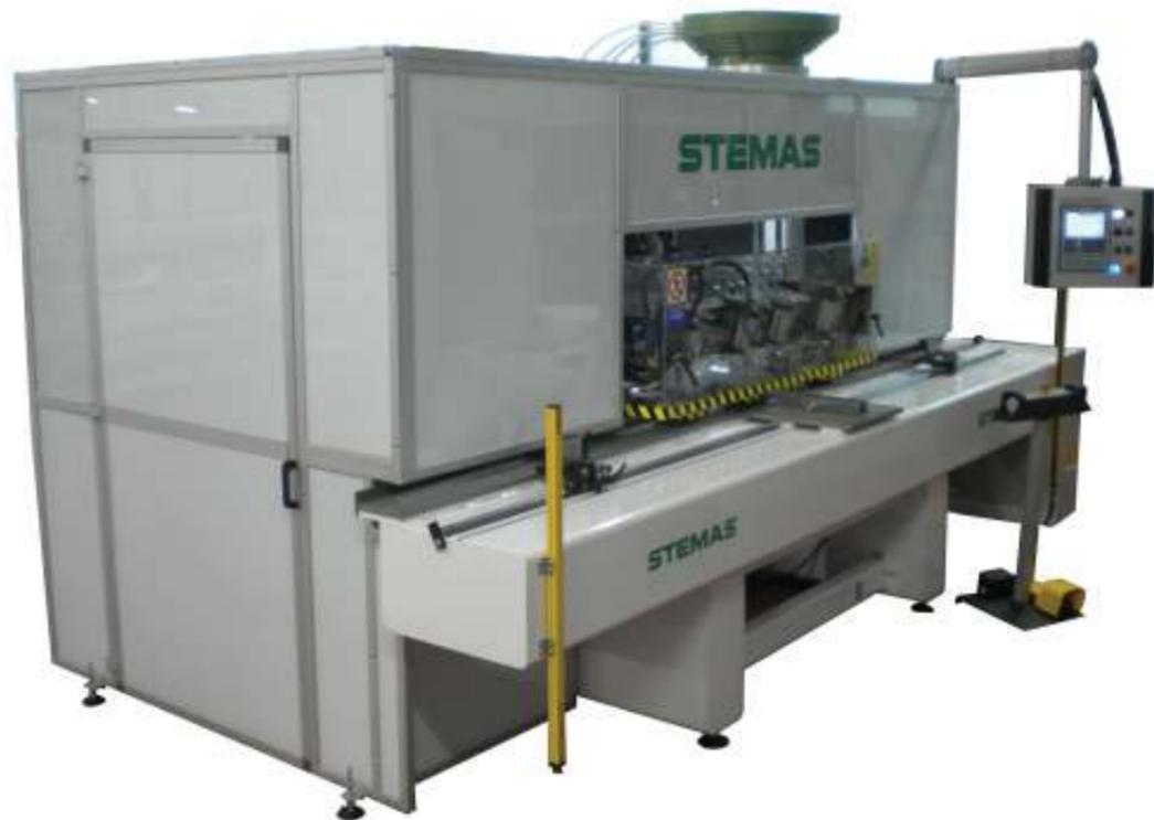
MÁQUINA ESTÁTICA PARA FRESAR, TALADRAR E INSERTAR CLAVIJAS EN LOS MONTANTES Y TRAVESAÑOS DE LAS PUERTAS CON JUNTA TIPO FRANCESA
