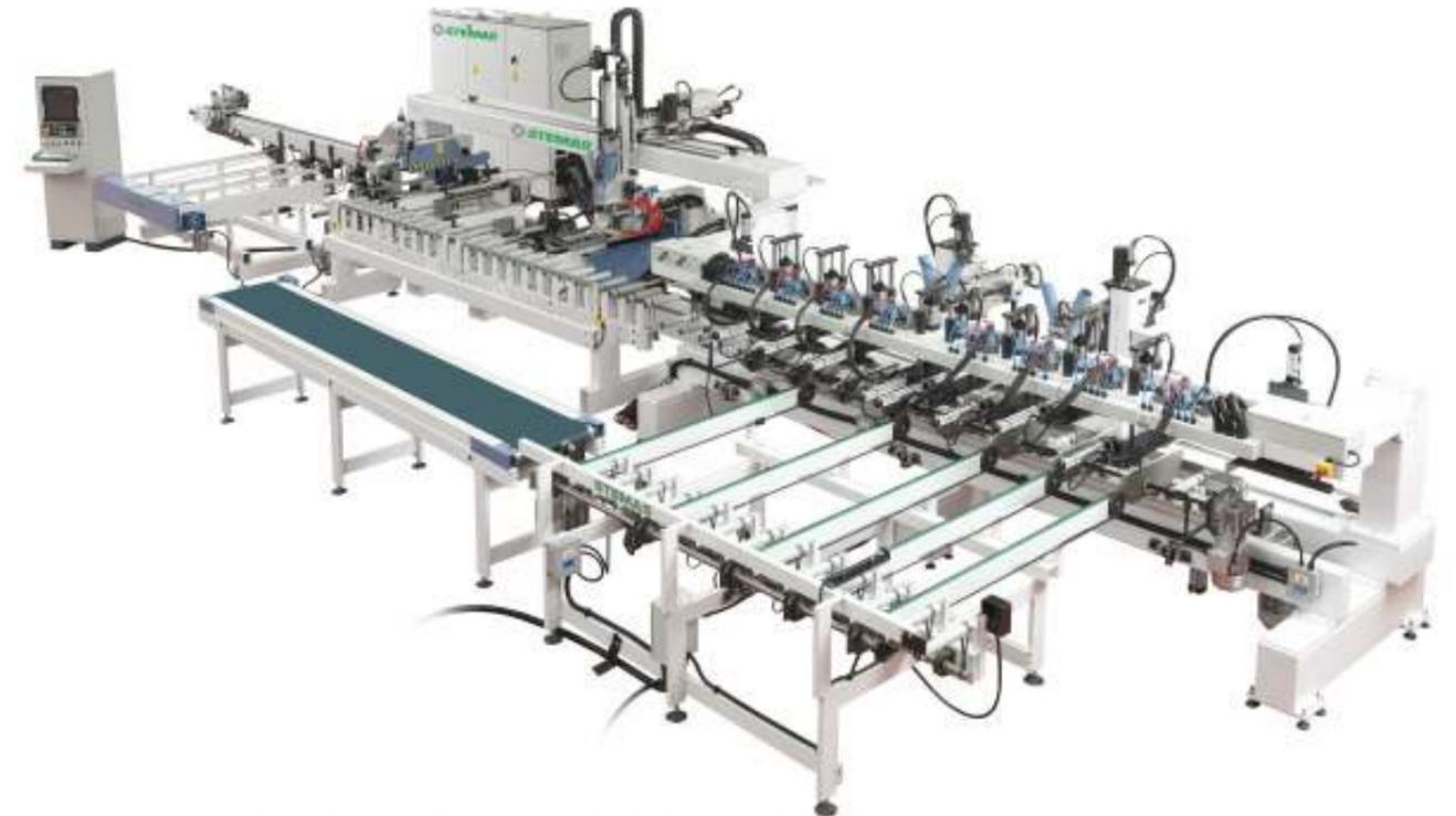
**PERFECT-JAMB-HP** ES UNA LÍNEA CON ALTA PRODUCTIVIDAD Y PERSONALIZABLE PARA LA PRODUCCIÓN DE BATIENTES, CARGADOR CON PINZAS A CNC E INSERTADO DE JUNTAS, CORTES A 45° Y 90°, TALADROS PARA ENSAMBLAJE, FRESADOS PARA CERRADURAS Y BISAGRAS, TALADRADO Y ATORNILLADO DE ANUBAS Y BISAGRAS.
