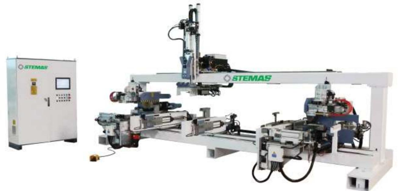
**EASY-JAMB** ES LA SOLUCIÓN SIMPLE Y PERSONALIZABLE PARA EL MECANIZADO DE BATIENTES, CORTES A 45° Y 90°, TALADROS PARA ENSAMBLAJE, FRESADOS PARA CERRADURAS Y BISAGRAS, TALADRADO Y ATORNILLADO DE ANUBAS Y BISAGRAS.
