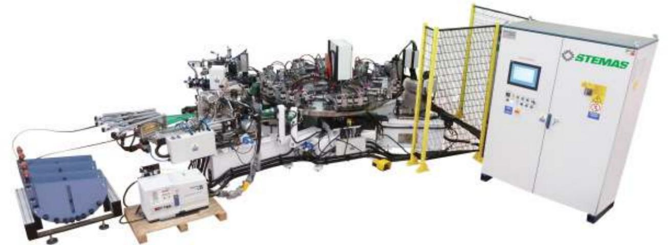
**ROTARY** ES UN CENTRO DE TRABAJO CON BANCADA GIRATORIA, PERSONALIZABLE PARA DISTINTOS PROCESOS DE TRABAJO: CANTEADO, REFILADO, ABRILLANTADO, FRESADO Y LIJADO
