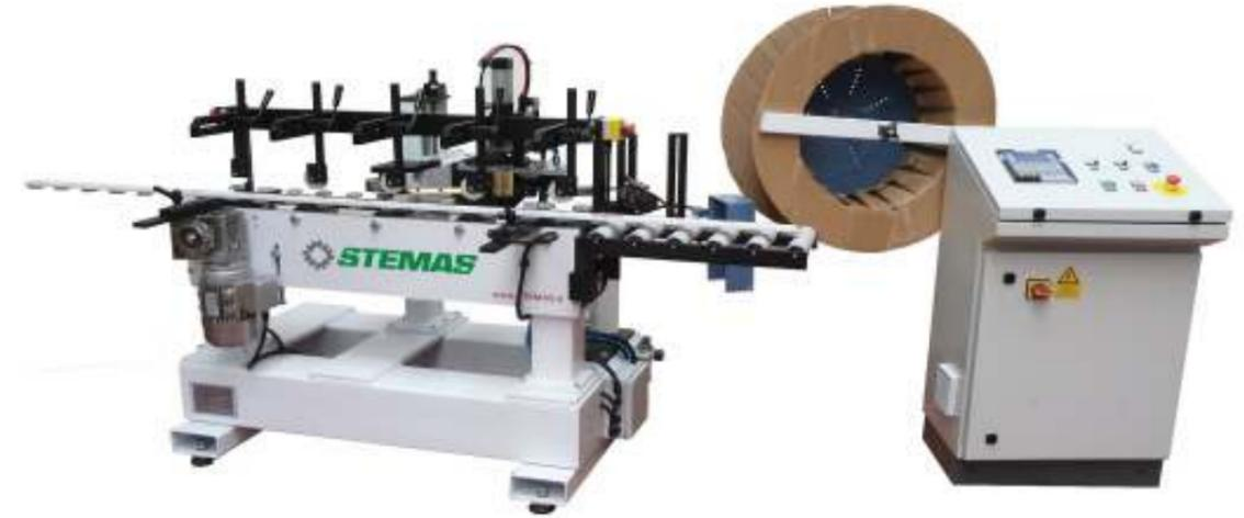
MÁQUINA PARA EL INSERTADO DE JUNTAS
